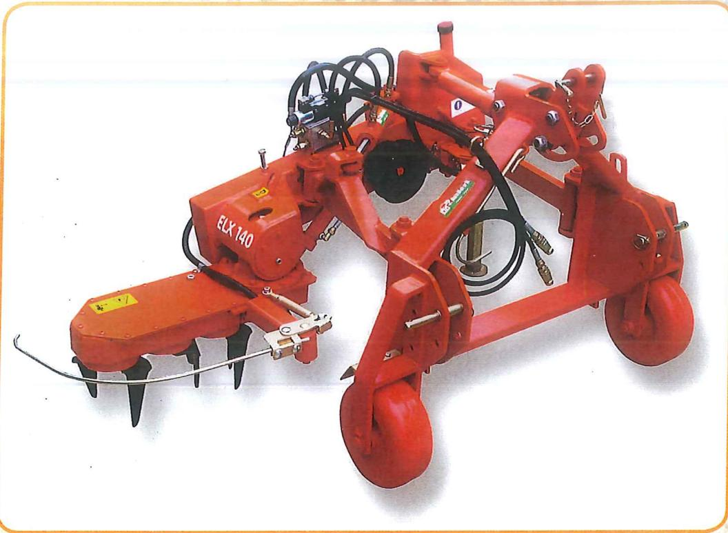
**Coltivatrice** interceppi ELX abbina ridotte misure di ingombro alla massima robustezza per una grande affidabilità anche in condizioni estreme. Dotata di 3 bracci per lo spostamento, di un dispositivo antiurto con molla a gas per attutire i colpi più violenti e cardano con limitatore a nottolini. E' adatta ai clienti più esigenti che devono lavorare in condizioni molto difficili, terreni molto compatti e sassosi. A richiesta è disponibile un sistema di guida automatico RSA.
