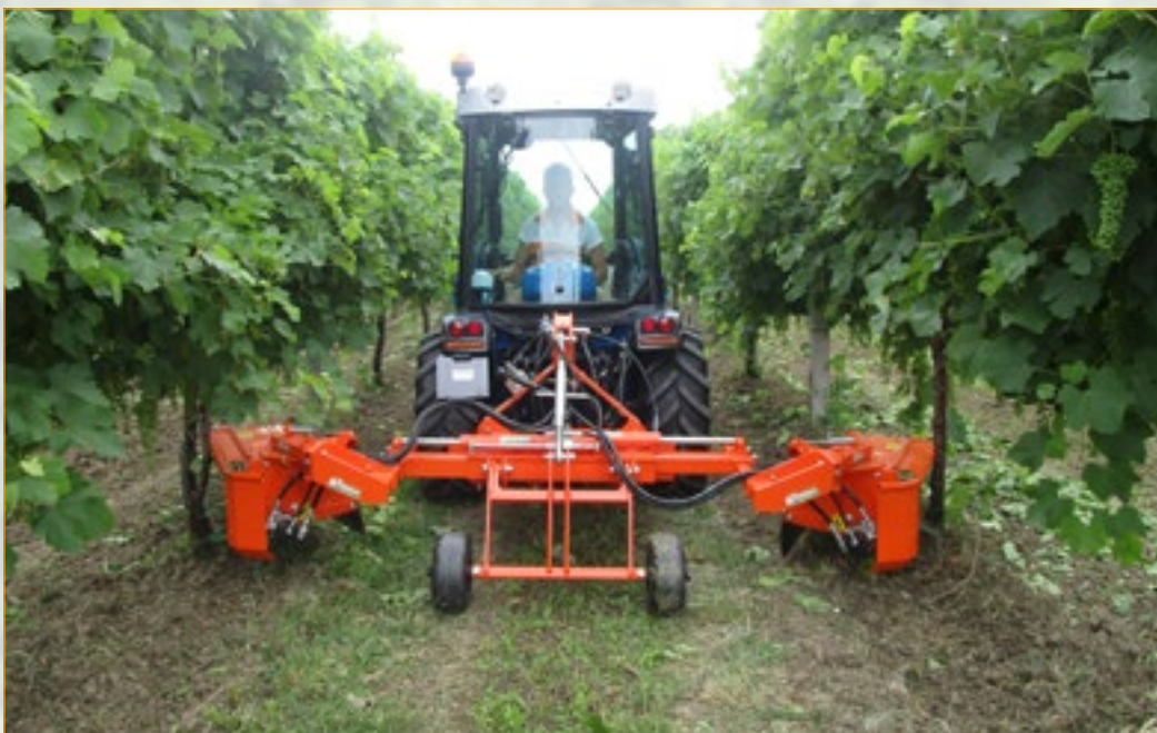
Flagelli per erba Whips for grass Fouets pour l' herbe Bürste für Gras Látigos para hierba
