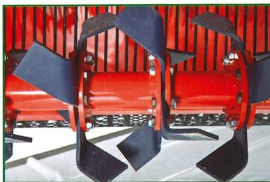
Viene utilizzata per interrare sassi e residui vegetali quali radici, resti di potatura e piccoli arbusti mediante appositi utensili chiamati zappe a vanga che nel terreno estirpano il sasso proiettandolo verso la griglia di selezione. Nella fotografia a lato viene raffigurato il rotore con le apposite zappe a vanga montate in configurazione doppia flangia.
