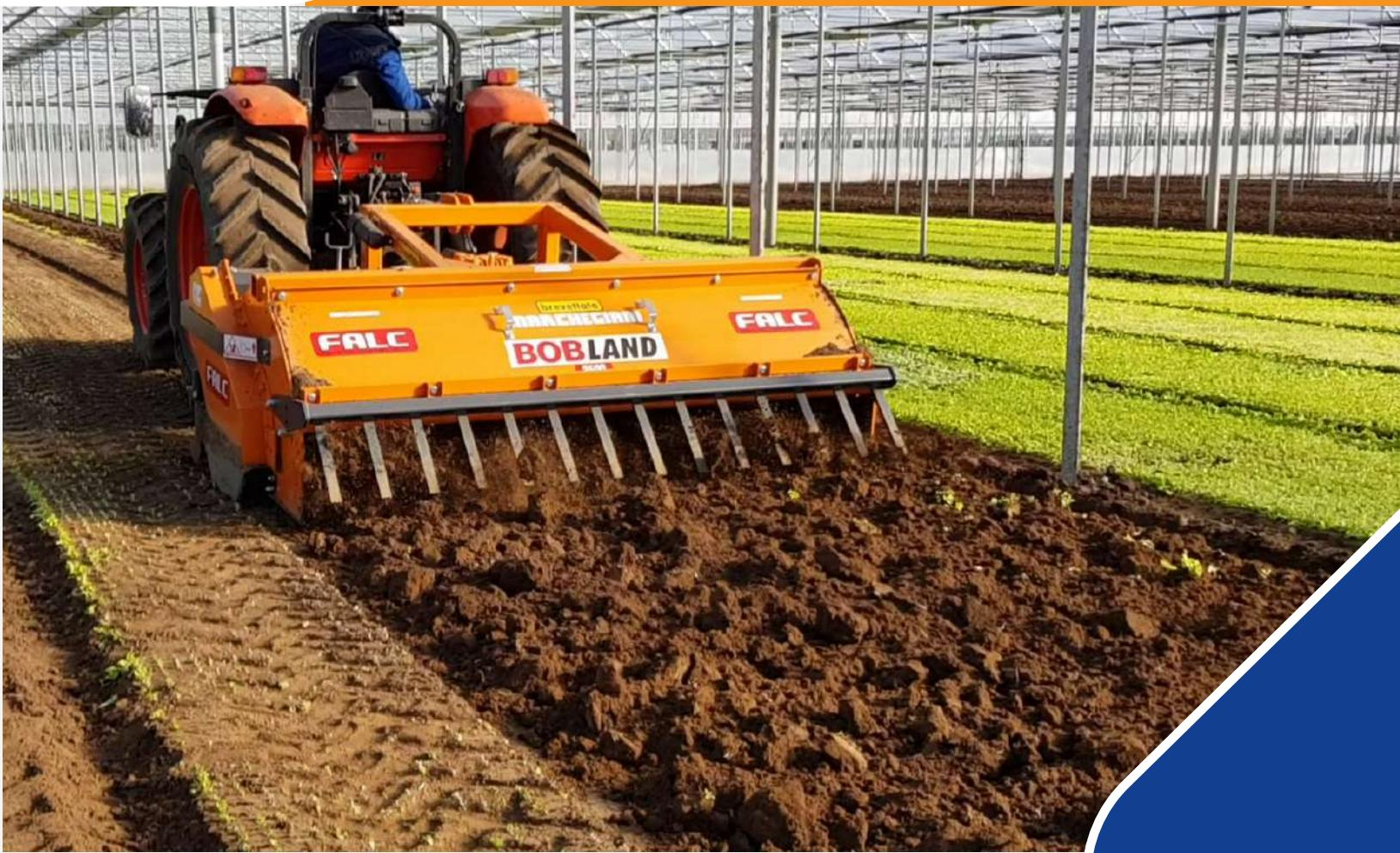
Aratro rotativo ideale per la lavorazione del terreno destinato alla coltivazione di ortaggi sia in campo aperto sia in serra. Per trattori da 80 a 120 HP
