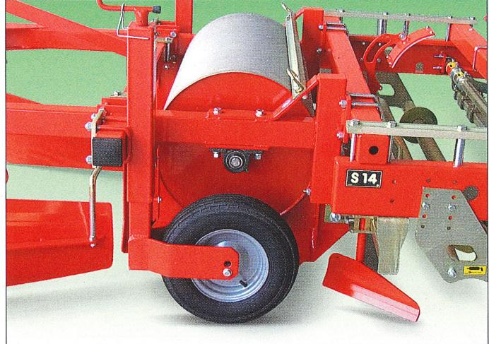
Dischi posteriori di grande diametro per rincalzatura ottimale anche in presenza di terreni difficili (sassi, zolle di grandi dimensioni); regolabili in profondità, larghezza ed inclinazione. Raschietto per pulizia interna e molla per carico variabile
