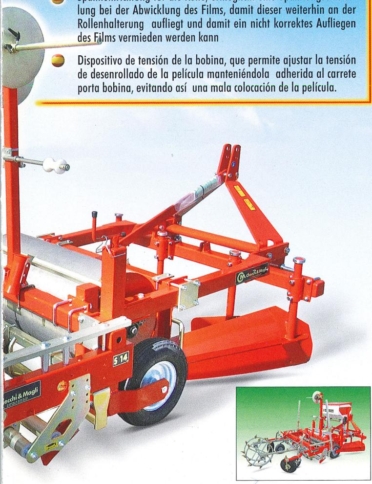
Dispositivo di tensione bobina, permette di regolare la tensione di srotolamento del film in modo da mantenerlo aderente al rullo porta bobina evitando una scorretta posa del film
