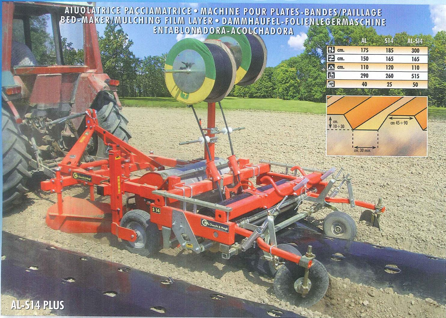
Effettua contemporaneamente l'aiuolatura del terreno e la deposizione del film di pacciamatura, ideale per le coltivazioni di fragole. Idonea per la realizzazione di letti di semina o di trapianto rialzati, con e senza film di pacciamatura.
