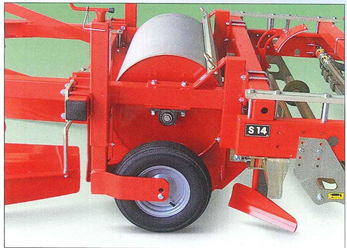
Ruote appoggio con pratico registro a manovella per una precisa regolazione dell'altezza del rullo inox da terra; sganciabili facilmente per utilizzo singolo della pacciamatrice S14
