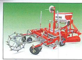
Dischi posteriori di grande diametro per rincalzatura ottimale anche in presenza di terreni difficili (sassi, zolle di grandi dimensioni); regolabili in profondità, larghezza ed inclinazione. Raschietto per pulizia interna e molla per carico variabile
