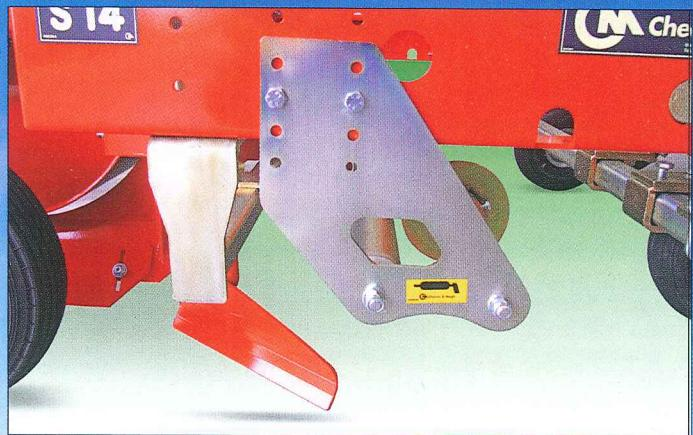
Supporto altezza rulli, le piastre di attacco a più fori permettono di regolare la distanza dei rulli da terra al variare dell'altezza dell'auola
